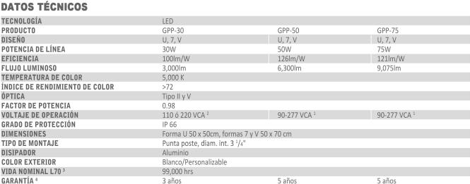
1. Rango de ajuste automático. 2. Selección manual de voltaje. 3. Mantenimiento del 70% del flujo lumínico inicial. 4. Contra de defectos de fabricación y mano de obra.
